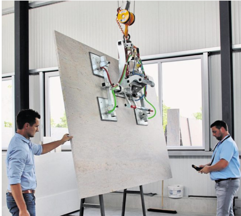
Daniel (rechts) und Manuel Plank demonstrieren, wie man eine Granitplatte, die eine halbe Tonne Gewicht hat, zur weiteren Bearbeitung mit einer speziellen Maschine anhebt. Bild: Dobler
